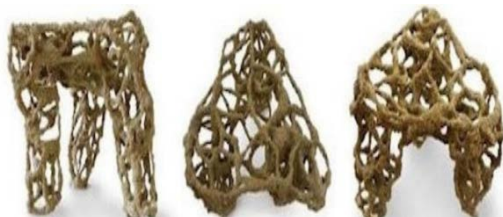
Рис. 3. Рабочие образцы, полученные способом компонентной склейки
