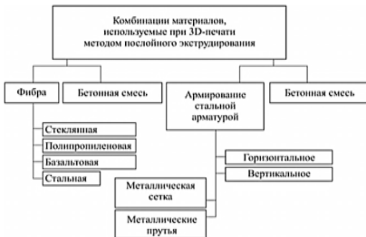
Рис. 5. Материалы, используемые при послойном экструдировании
