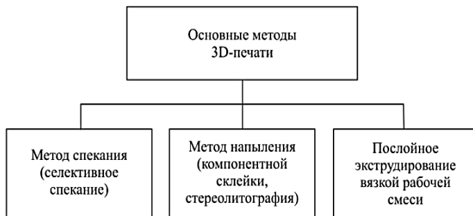
Рис. 1. Основные методы 3D-печати, используемые в строительстве
