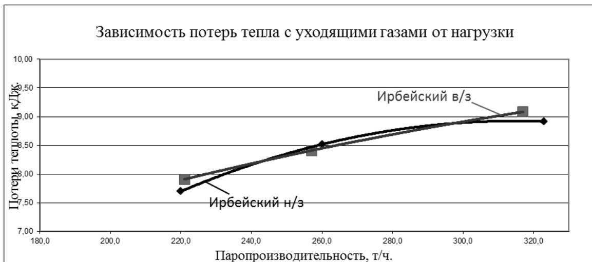
Рис. 4. График зависимости потерь тепла с уходящими газами от нагрузки
