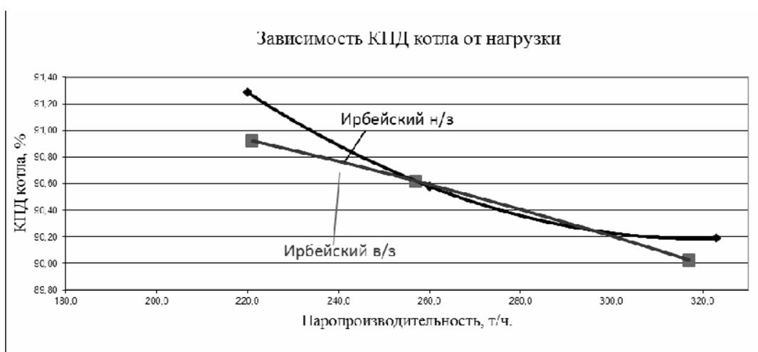
Рис. 6. График зависимости КПД котлоагрегата от нагрузки
