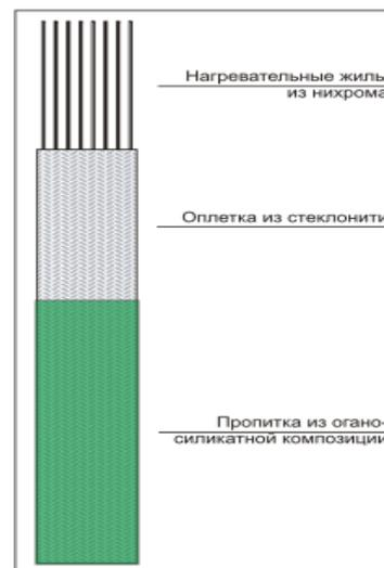
ЭНГЛУ-400 (элемент нагревательный гибкий ленточный унифицированный) - это промышленного качества гибкая нагревательная лента, которая может использоваться для разогрева и компенсации теплотерь резервуаров, трубопроводов и другого технологического оборудования, которая нагревается до температуры в 400°C (рис. 2)
