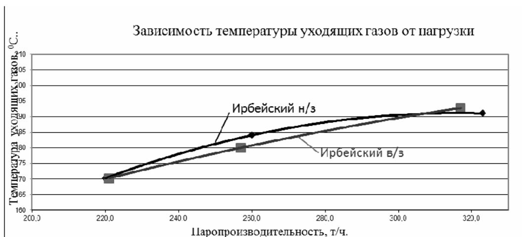
Рис.5. График зависимости температуры уходящих газов от нагрузки
