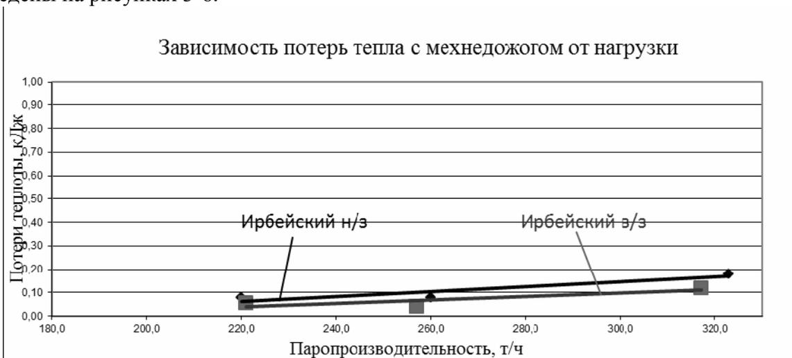
Рис. 3. График зависимости потерь тепла с мехнедожогом от нагрузки
