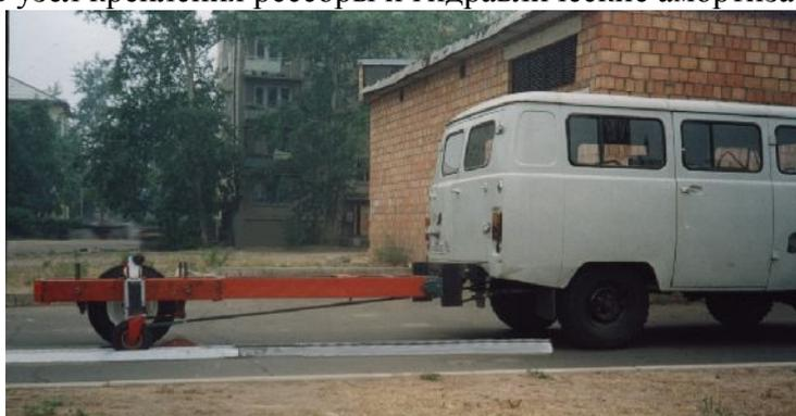
Рис. 5. Дорожная лаборатория для ходовых испытаний пневматических шин с жестким креплением колеса к раме полуприцепа
