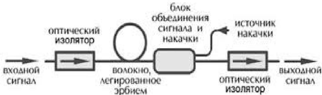
Рис.1 Схема эрбиевого оптического усилителя
