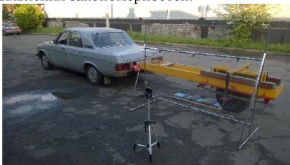
Рис. 9. Одноколесный полуприцеп с поддресоренным креплением колеса к раме
