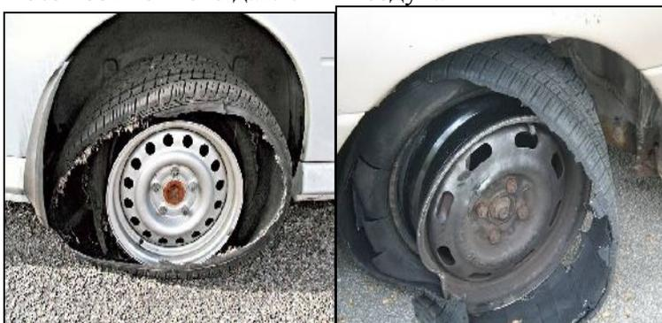
Рис.1. Автомобильные колёса с разрушенными пневматическими шинами
