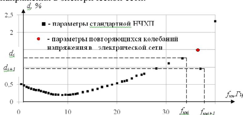
Рис. 1. Графическая интерпретация НЧХФ для лампы накаливания мощностью 60 Вт и колебаний напряжения в электрической сети
