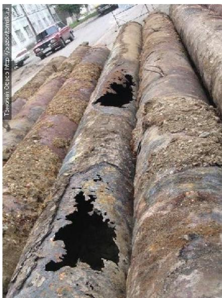
Рис. 2. Наружная коррозия тепловых сетей
