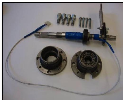
Рис. 4. Ступица тензометрическая [3]
