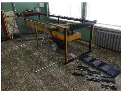
Рис. 8. Испытания шин на модернизированном полуприцепе в лабораторных условиях
