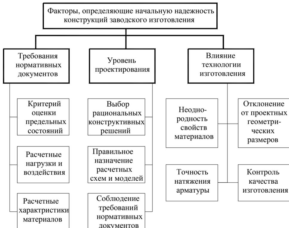
Рис. 2. Факторы, определяющие начальную надежность железобетонных конструкций заводского изготовления
