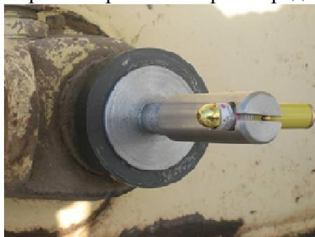
Рис. 1. Излучатель на проушине гильзы
