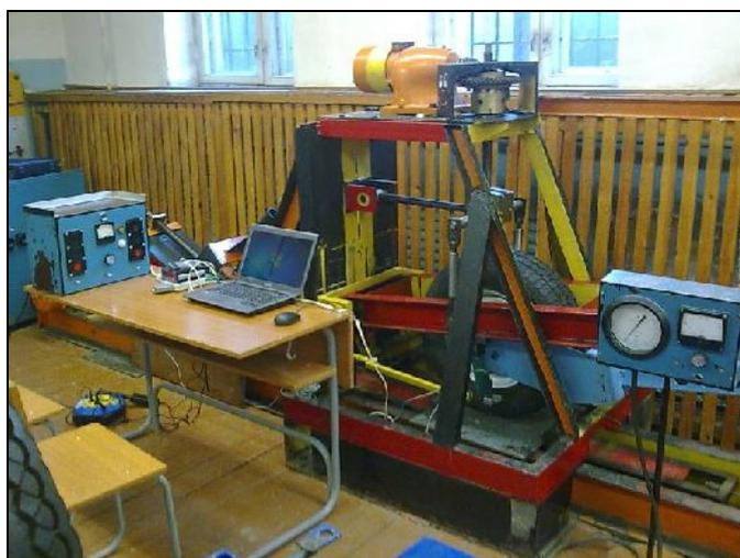
Рис.5. Испытательный комплекс для экспериментальной оценки поглощающей и сглаживающей способности автомобильных шин
