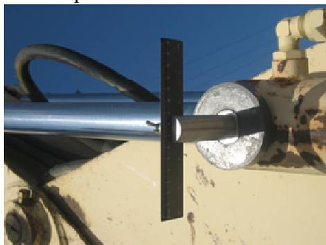
Рис. 3. Промежуточный приёмник на гильзе гидроцилиндра
