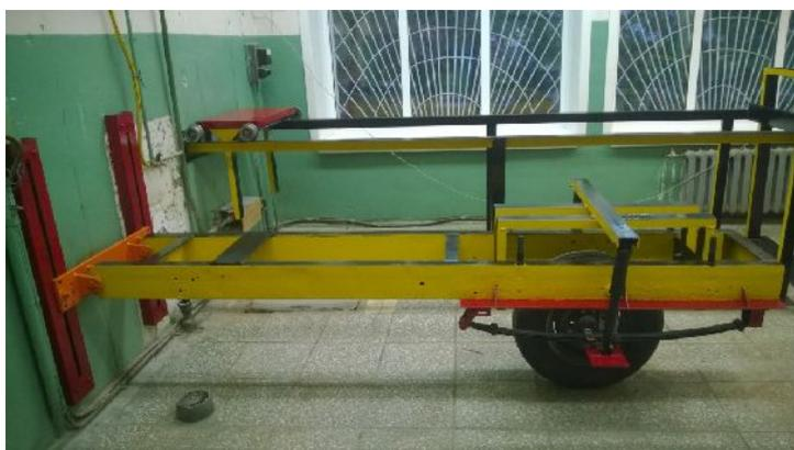
Рис. 6. Одноколесный полуприцеп с поддрессоренным креплением колеса к раме
