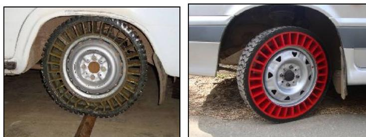
Рис. 3. Экспериментальные образцы автомобильных колёс с безвоздушными полиуретановыми шинами
