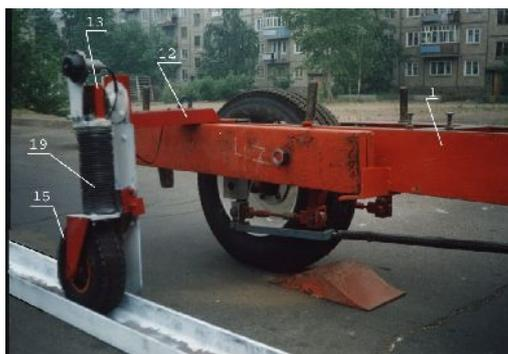
Рис. 7. Дополнительная колесная стойка, смонтированная на раме полуприцепа: 1 – рама полуприцепа; 12 – кронштейн; 13 - подшипниковый корпус; 15 – колесо; 19 - направляющий цилиндр.
