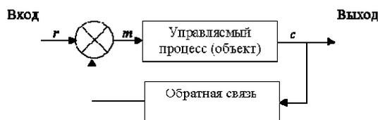
Рис.2. Схема управления с обратной связью (простая замкнутая система)
