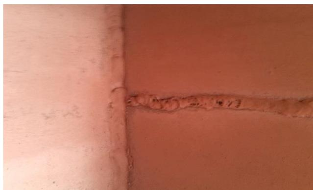
Рис.1. Дефект сварного соединения в виде несплавления
