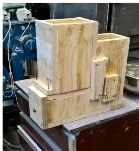
Рис.5. Опалубка для испытания образца №2
