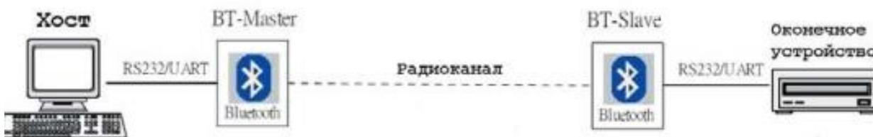
Рис.5. Схема передачи данных при использовании Bluetooth
