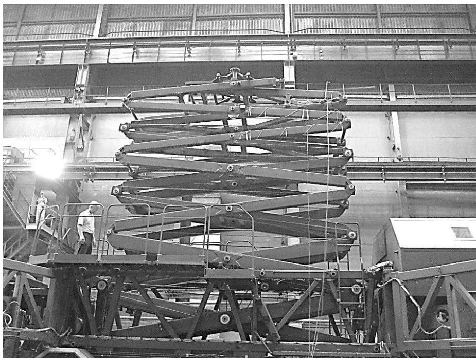
Рис. 1. Общий вид специального пантографного подъемника мобильного узла связи
