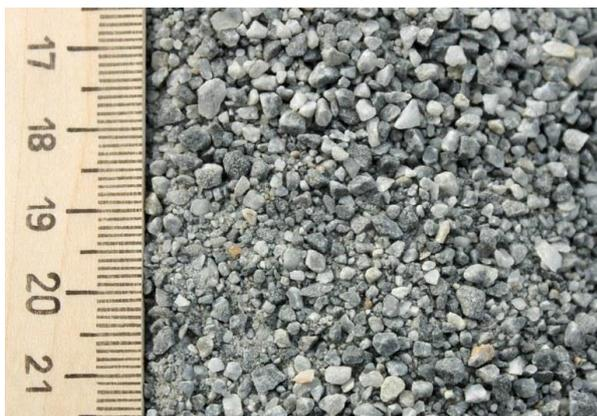
Рис. 4. Кварцевый песок с фракционным составом 1 -1.6мм.
