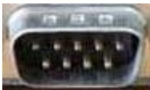
Рис.3. Разъём DB-9 (Последовательный порт)
