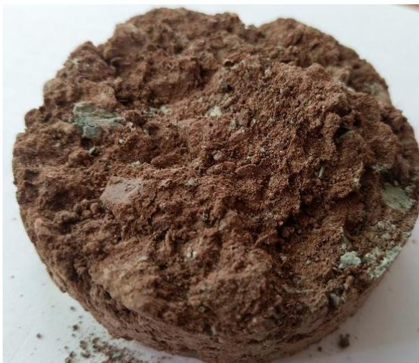
Рис. 4. Поверхность среза образца глинистого грунта с включением цемента алевролита
