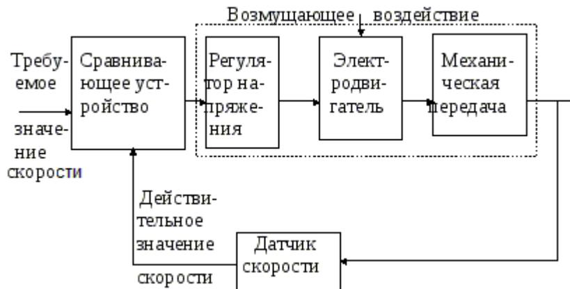
Рис.4. Схема с датчиком для измерения скорости вращения выходного вала
