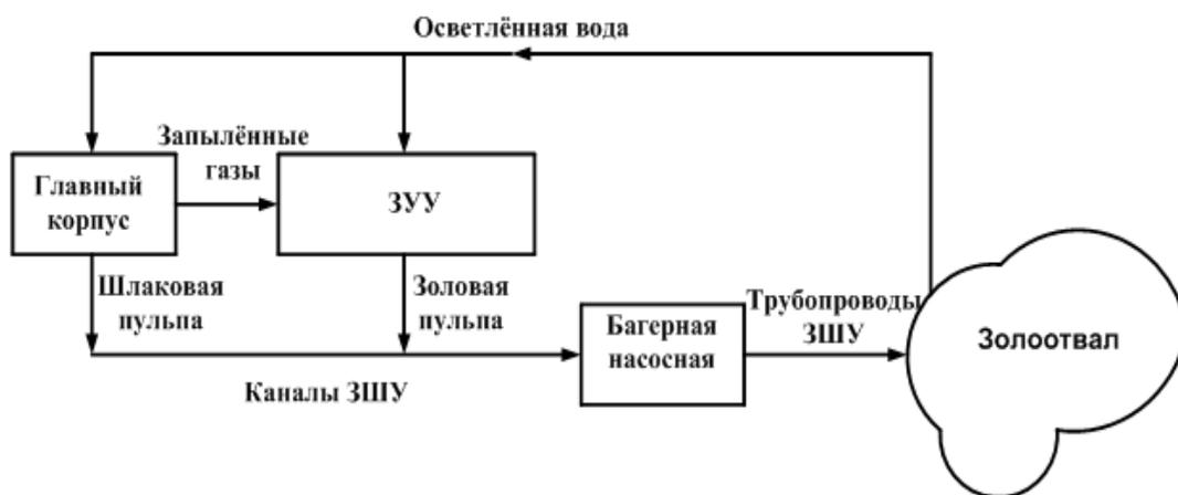
Рис. 1. Структурная схема системы ЗШУ на ТЭС-6
