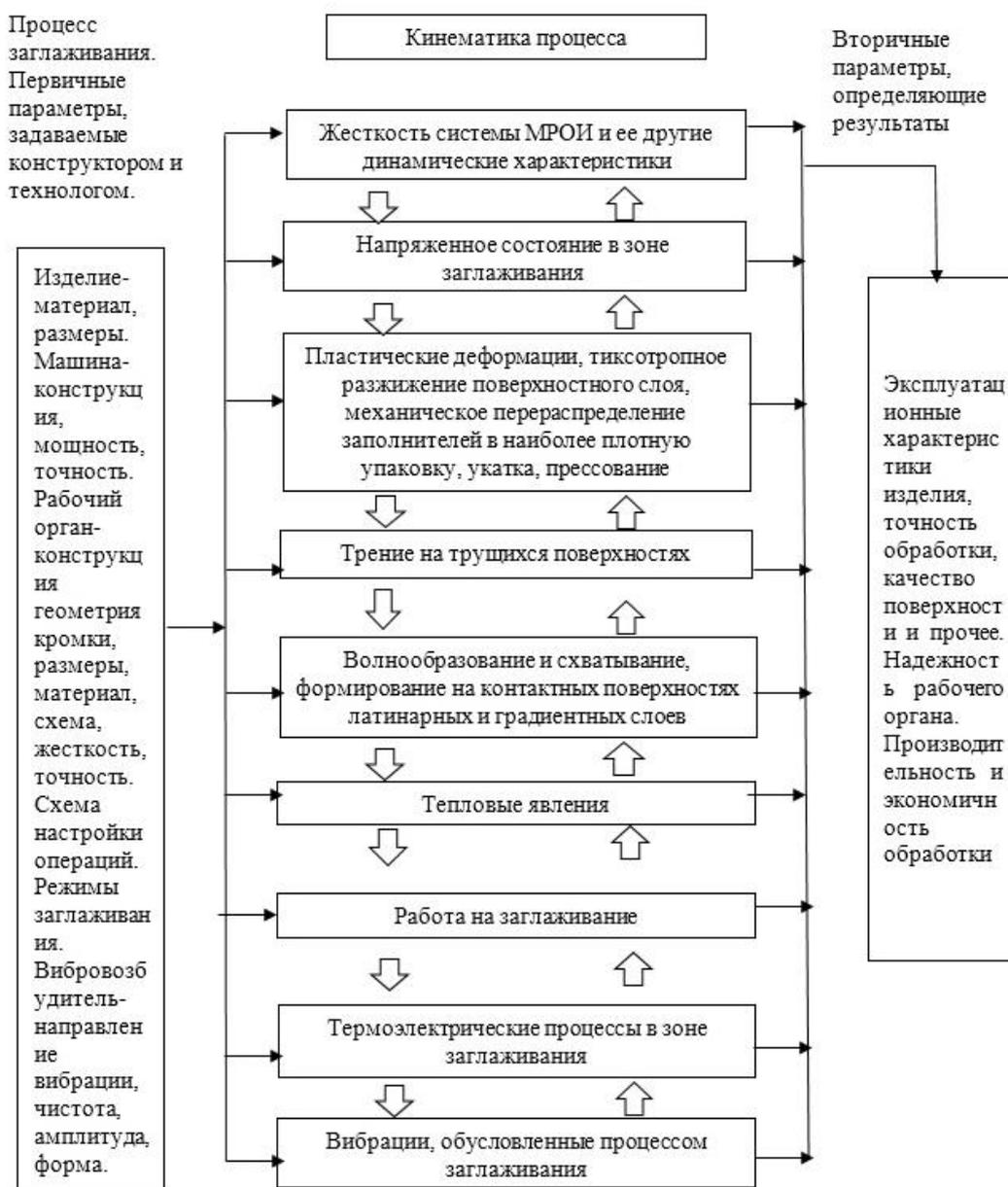
Рис. 1. Структурная схема обработки незатвердевших бетонных поверхностей
