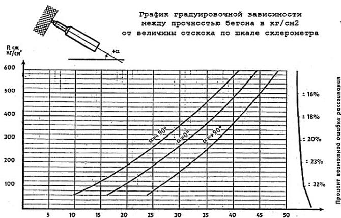
Рис.2. График градуировочной зависимости прочности бетона от величины отскока по шкале склерометра
