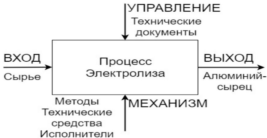
Рис. 1. Модель процесса электролизного производства
