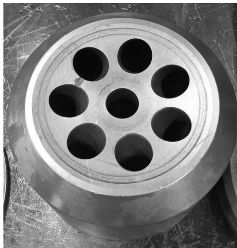
Рис. 2. Типичный случай дефекта блока цилиндров гидромотора BoshRexroth A6VM/VE 160
