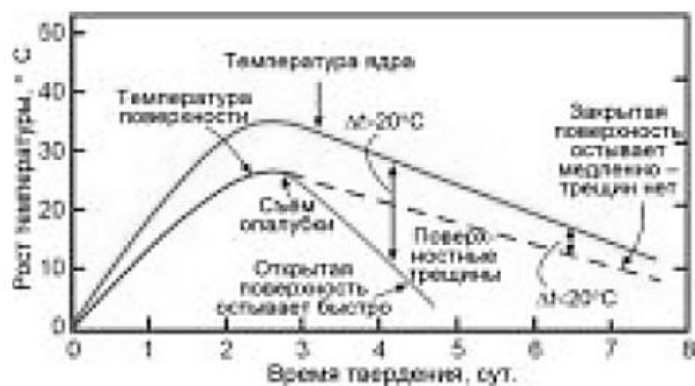
Рис. 1. Условие для растрескивания поверхности бетонного массива после распалубки - критический температурный градиент \Delta t = 20^\circ\text{C} .
