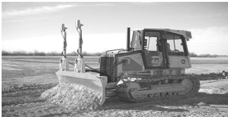
Рис.1. Автоматическая лазерная система на бульдозере
