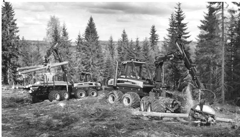
Рис. 1. Харвестер и форвардер - совместная работа
