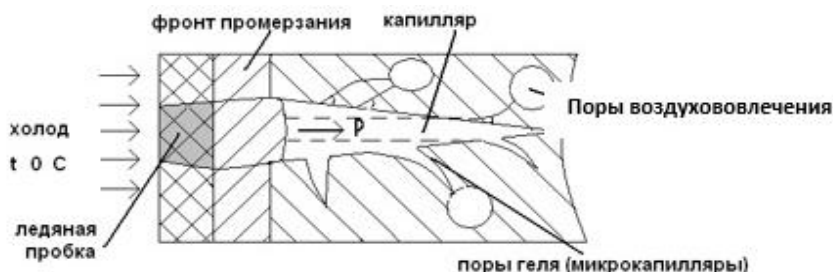
Рис.1. Процесс промерзания бетона за счёт капиллярных пор
