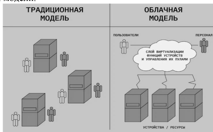
Рис. 1. Сравнительная характеристика традиционной и облачной модели
