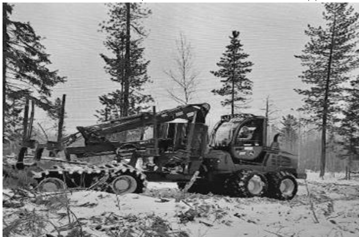
Рис. 1. Уплотняющее воздействие на почву форвардера
