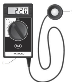
Рис. 3. Люксметр «ТКА-Люкс»: 1 – блок обработки сигналов; 2 – фотометрическая головка
