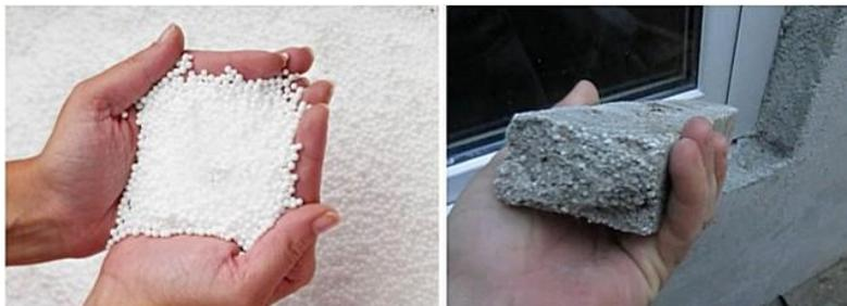
Рисунок 2 – Теплоизоляционный штукатурный слой с пенополистирольным наполнителем
