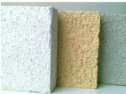
Рисунок 1- Теплоизоляционный штукатурный слой после высыхания
