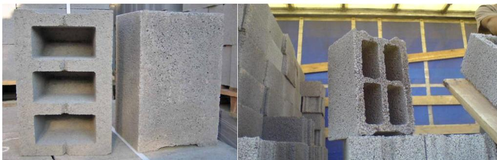
Рисунок 1 – Виды пустотелых блоков из золошлакобетона
