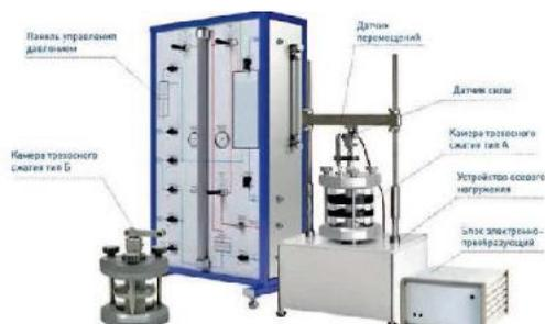
Рисунок 2 – Общий вид установки трехосного сжатия
