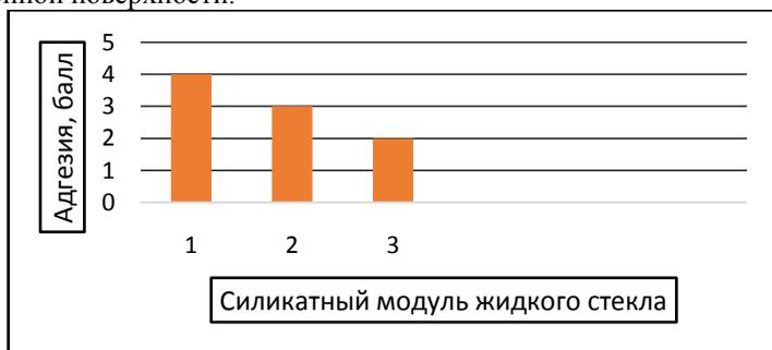
Рисунок 2 – Адгезия к бетонной поверхности в зависимости от силикатного модуля
