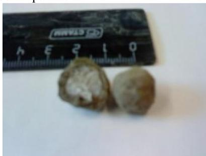
Рисунок 2 – Облегченный безобжиговый зольный гравий с сердцевиной из вторичного пенополистирола, в разрезе
