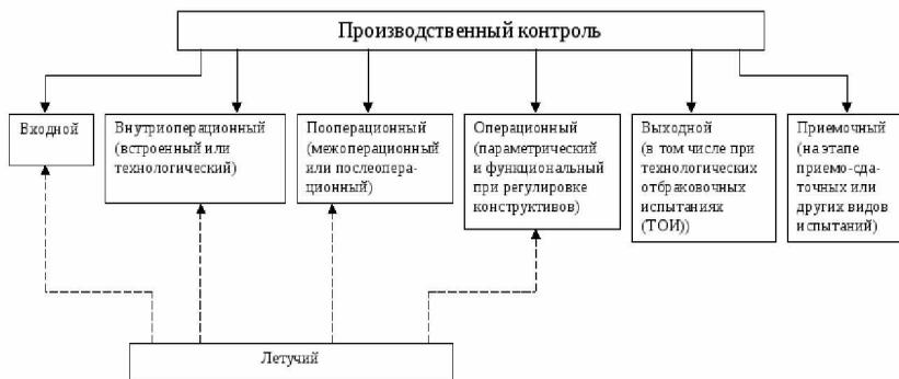
Рисунок 1 – Схема производственного контроля
