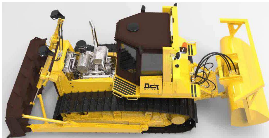
Рис. 3. Компоновка бульдозера с установленным мульчером
