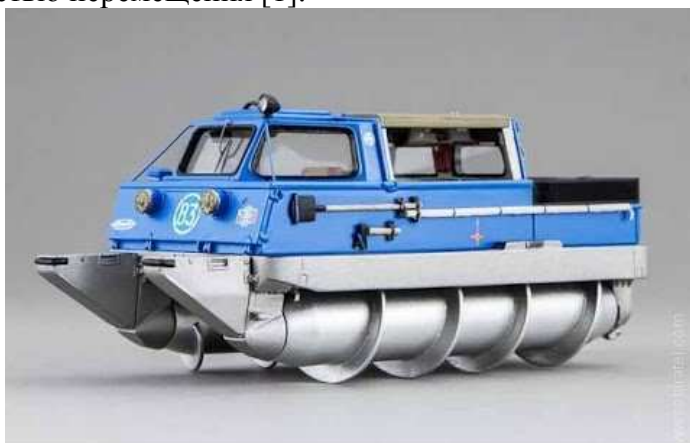
Рис. 1-Шнекоход-шнековый вездеход, оснащенный двумя шнековыми движителями
