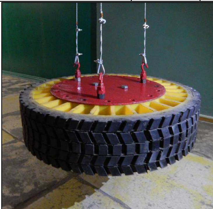
Рис. 3. Трифилярный подвес автомобильного колеса с безвоздушной шиной
