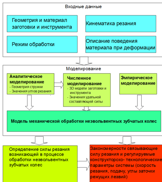
Рис. 2. Схема исследования влияния регулируемых конструкторско-технологических параметров системы на силу резания, возникающую в процессе обработки невольвентных зубчатых колес
