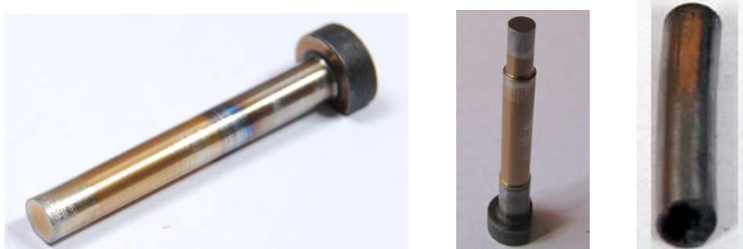
Рис.2. Характер износа упрочненных объемной закалкой пробивных пуансонов
