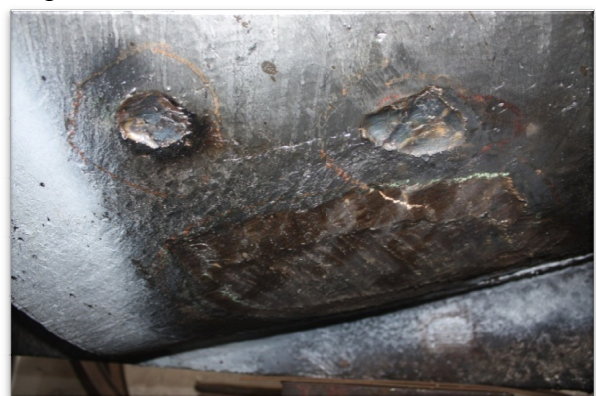
Рис. 2. Износ поверхности лопатки рабочего колеса.
