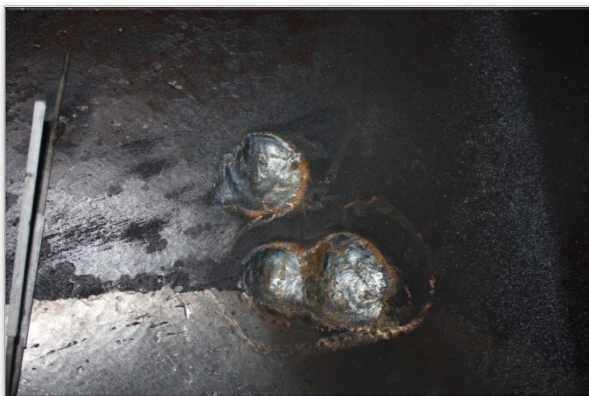
Рис. 2. Износ поверхности лопатки рабочего колеса.
