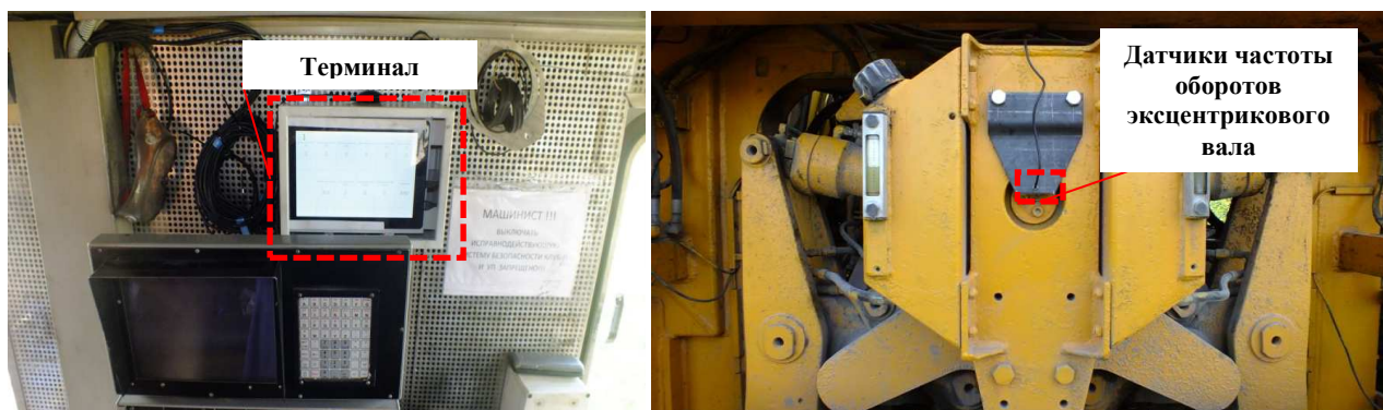
Рисунок 1 – Бортовой терминал и датчик частоты вращения эксцентрикового вала, установленные на путевую машину
