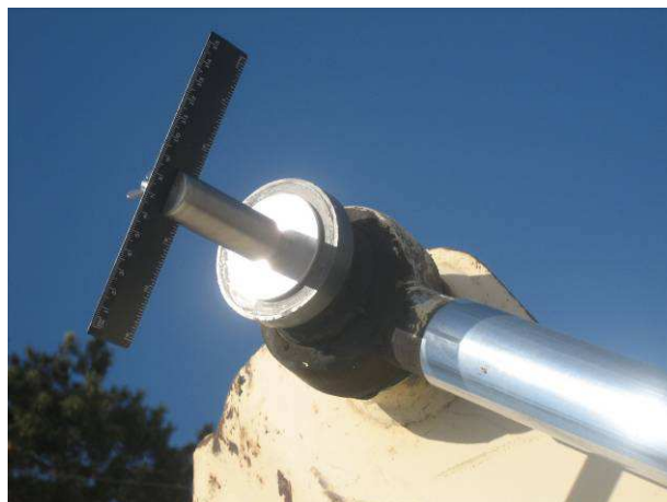
Рис. 3. Конечный приёмник на проушине штока.
