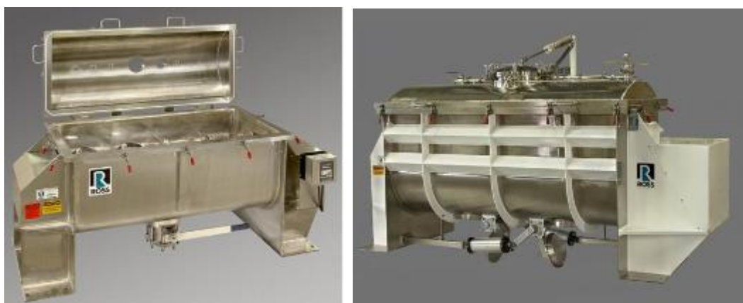
Рис.16 Ленточный смеситель: а) для пищевых продуктов, б) для строительных материалов.
