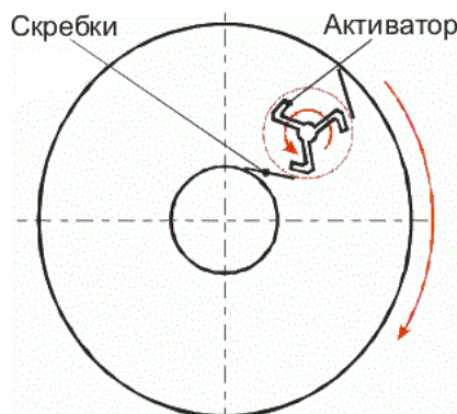
Рис.11 Смеситель с подвижной чашей и эксцентрично расположенным валом активатора
