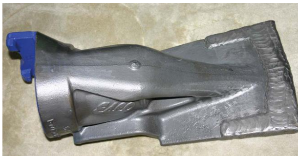
Рис. 1 Пример наплавки на коронке ковша экскаватора
