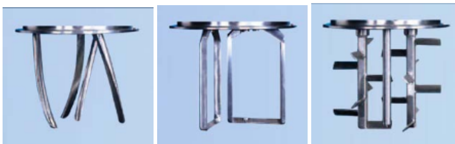
Рис.19 Варианты исполнения рабочих органов планетарного смесителя
