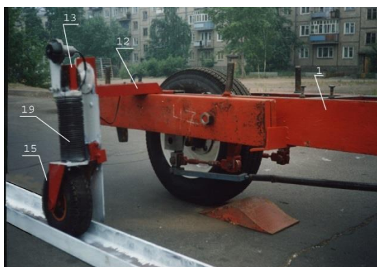
Рис.5 Вид одноколесного полуприцепа, оборудованного для ходовых испытаний шин на сглаживающую способность: 1 – рама полуприцепа; 12 – силовой кронштейн; 13 – датчик колебаний; 15 – самоустанавливающееся колесо измерительной стойки; 19 – упругий элемент измерительной стойки
