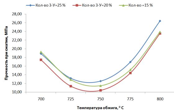
Рис. 1. Зависимость прочности при сжатии от температуры обжига
