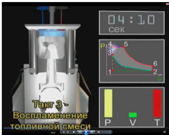
Рис. 2. Термодинамические процессы Цикла Тринклера
