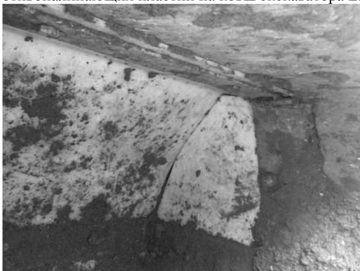
Рис. 2. Футерованный ковш экскаватора ЕК-18 в процессе работы
