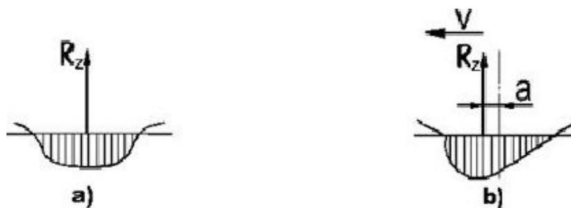
Рис. 1. Эпюры давлений в зоне контакта шины с дорогой:
