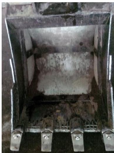
Рис. 1. Ковш экскаватора ЕК-18, футерованный противоналипающими пластинами
