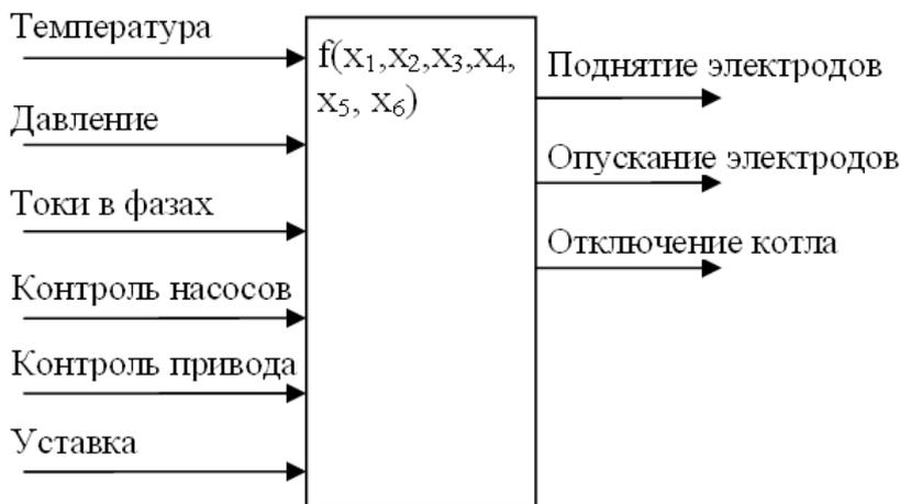
Рис. 2. Схема управления электродом
