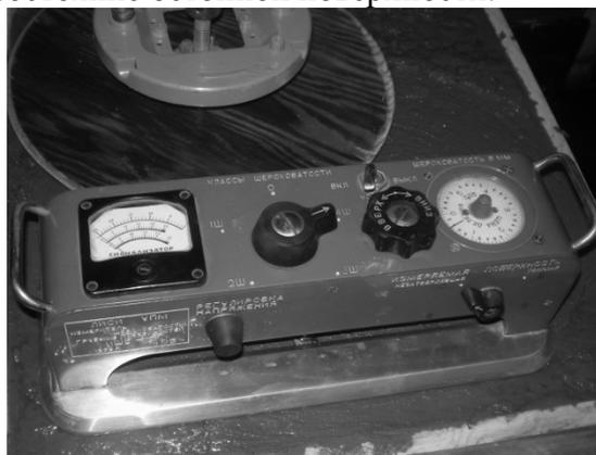
Рис. 1. Прибор для измерения шероховатости поверхности ИШБ – 6
