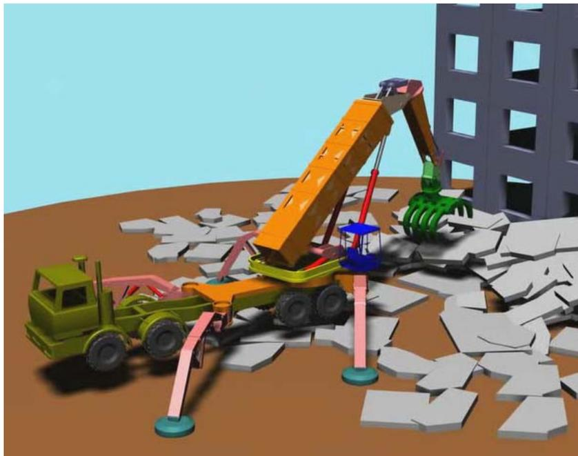
Рис. 1. Многофункциональная машина при разборке здания
