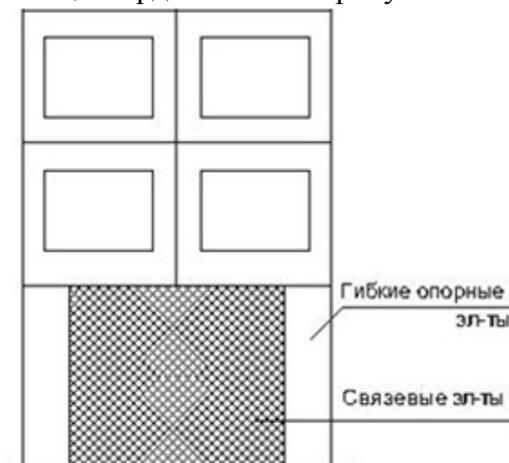
Рис. 7. Пример конструктивного решения зданий с выключающимися связями
