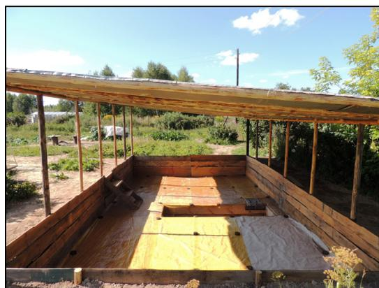
Фото. 1. Общий вид испытательной площадки. Размеры площадки в плане 5x9 м, заглубление 0,8 м
