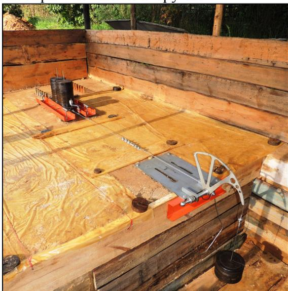
Фото. 2. Общий вид экспериментальной установки во время испытаний модели фундамента из 4-ех линейно расположенных свай
