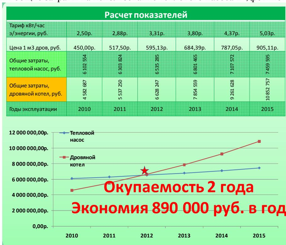
Рис. 2. Сравнение показателей экономической эффективности использования теплового насоса с твердотопливным котлом на дровах [2]
