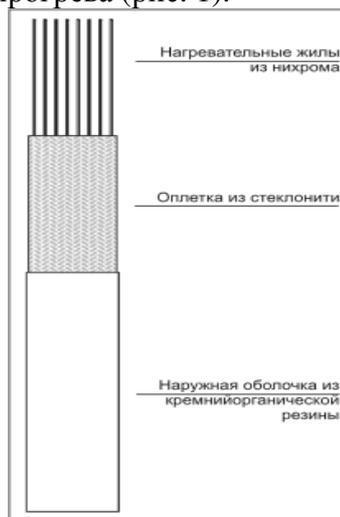
Рис. 1. Гибкий нагревательный элемент ЭНГЛ-1
