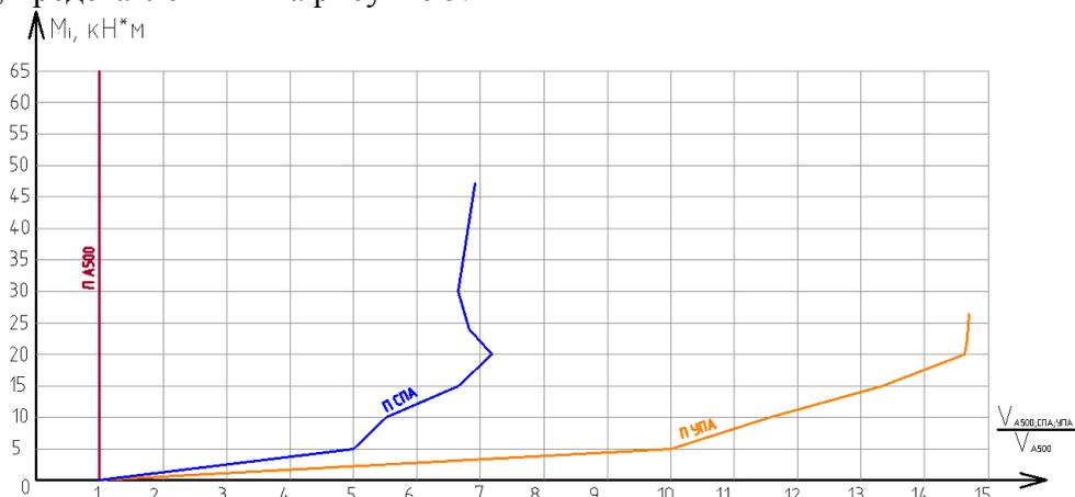
Рис. 3. График изменения относительного объема суммарных прогибов плит, армированных стальными, стеклопластиковыми и углепластиковыми стержнями при испытании
