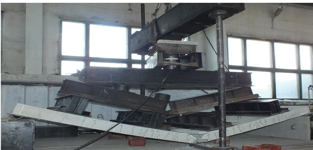
Рис. 2. Характерная схема разрушения плит сплошного сечения, армированных композитными стержнями
