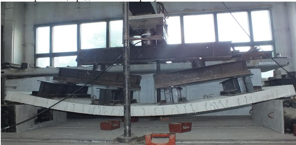
Рис. 1. Общий вид испытания натуральных плит сплошного сечения
