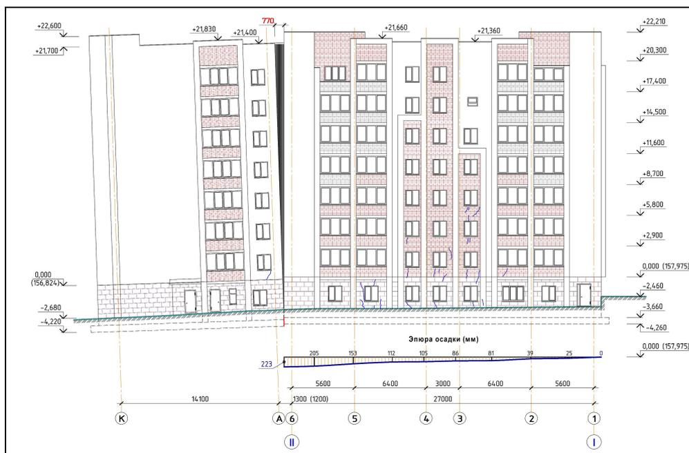
Рис. 1. Крен, осадки и расположение трещин в наружной стене секции №1, ориентированной по оси «К», на участке в осях «II-I»
