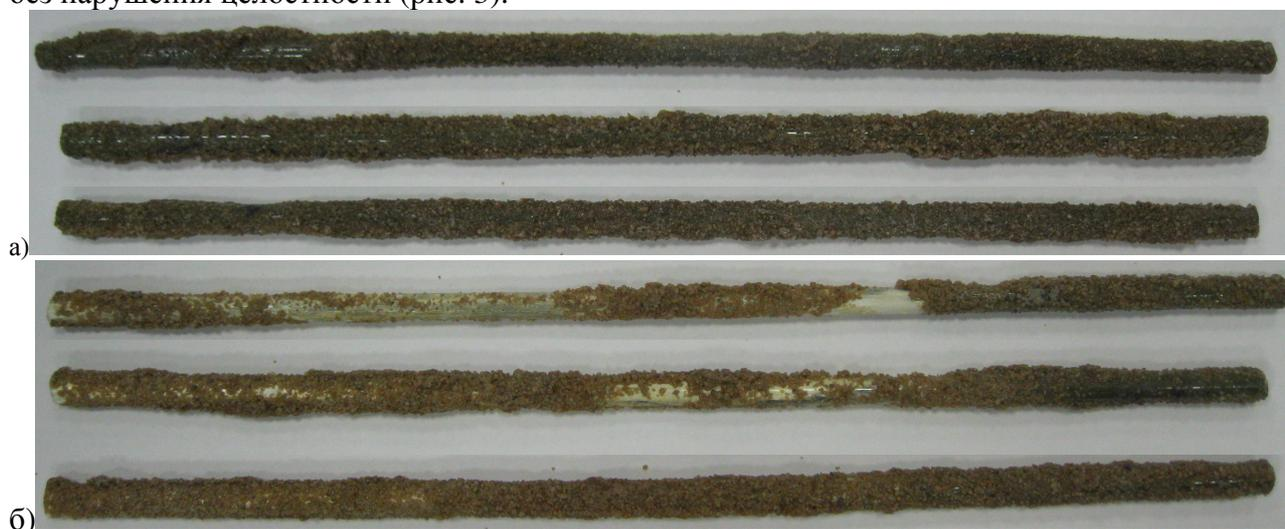
Рис. 2. Образцы углепластиковой арматуры
