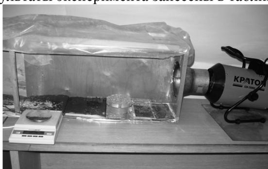
Рис. 4. Лабораторная установка для продувания дисперсного материала
