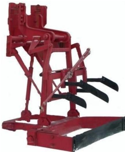
Рис.4. Корнеподрезчик навесной управляемый КНУ-1,2
