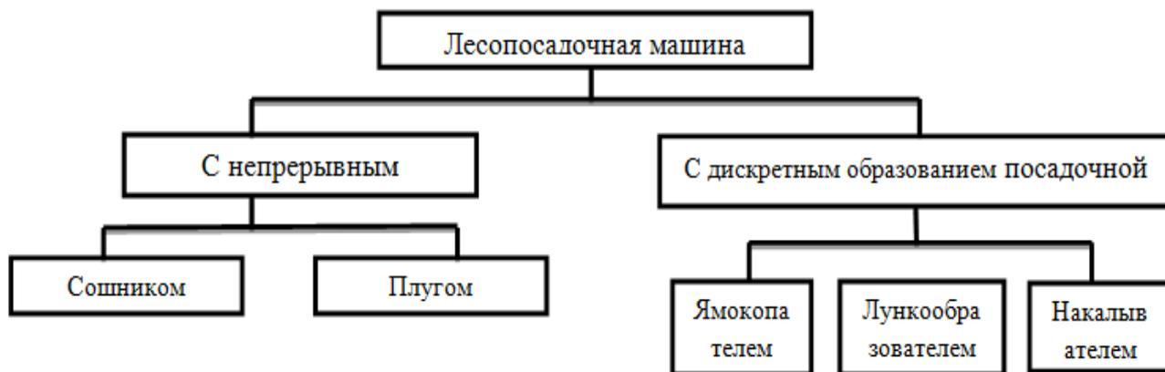
Рис. 1. Типы лесопосадочных машин
