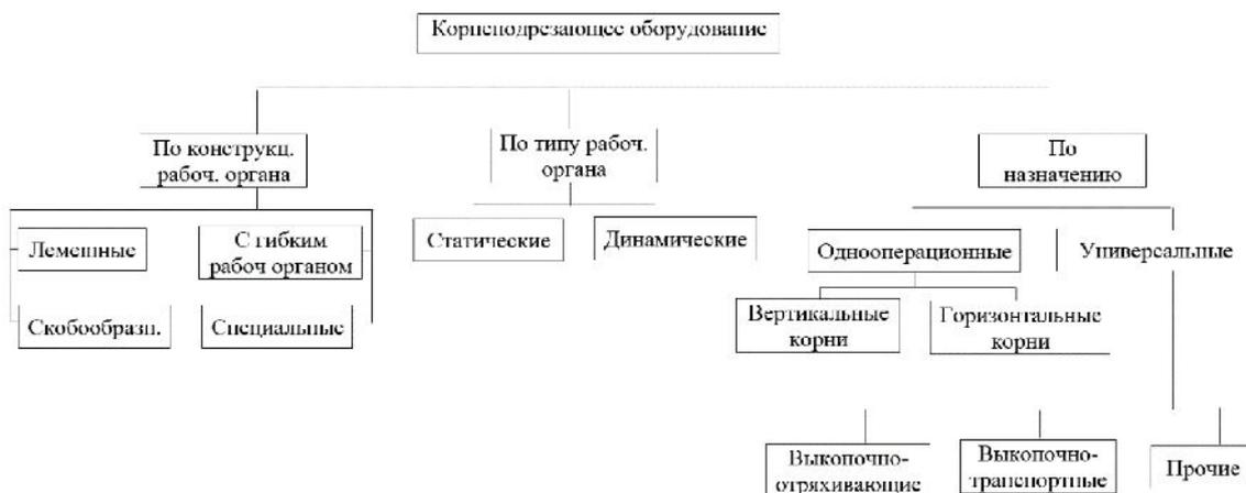
Рис. 1. Классификация оборудования для подрезки корней.
