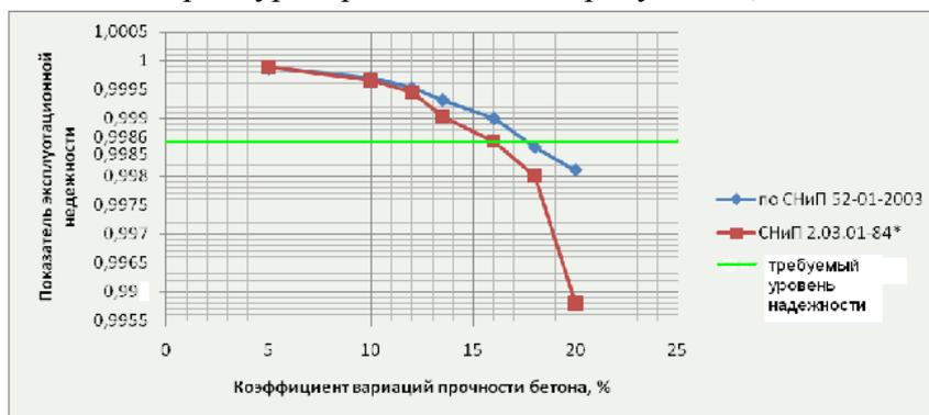
Рис. 1. Влияние коэффициента вариации прочности бетона на показатель эксплуатационной надежности колонны
