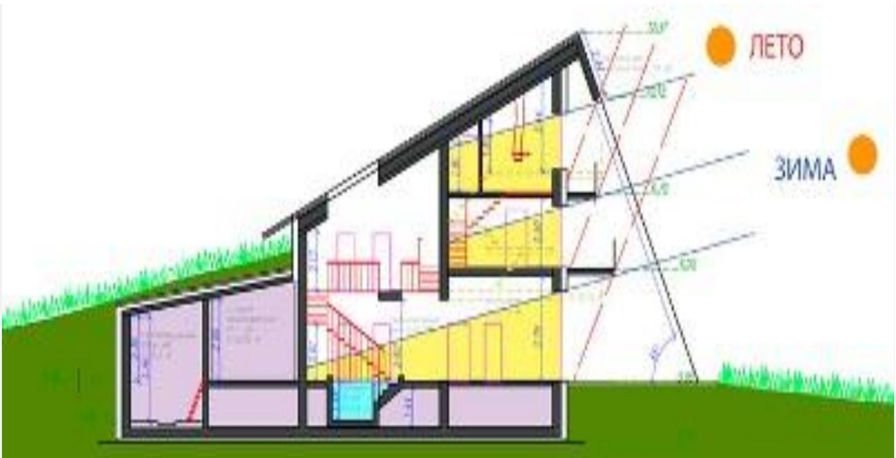
Рис. 1. Замещение традиционных источников тепла за зимний период 81% вклад пассивной солнечной системы отопления
