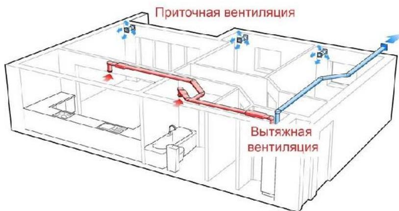
Рис. 1. Система приточно-вытяжной вентиляции в квартире
