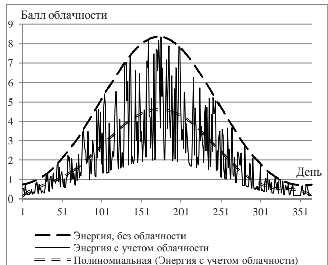
Рис. 7. Изменение валового потенциала солнечных модулей в течение года без учета облачности и с учетом облачности. Пунктирная линия — усредненная линия тренда
