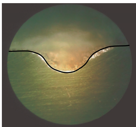
Рис. 6. Внешний вид кромки отверстия при P = 1 МПа
