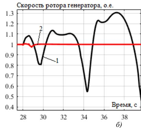
**Рис. 6.** Осциллограммы скорости ротора двигателя (а) и генератора (б) при трехфазном КЗ: 1 — классические АРВ и АРС; 2 — прогностические АРВ и АРС
