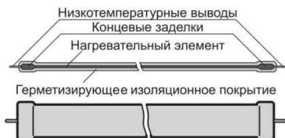
Рис. 1. Лента углеродная нагревательная гибкая (ЛУНГ)
