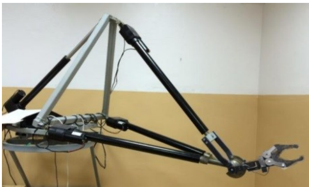
Рис. 3. Манипулятор-трипод с трехступенным захватом
