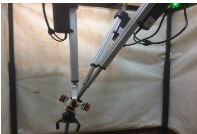
Рис.4. Манипулятор-трипод на неподвижном основании
