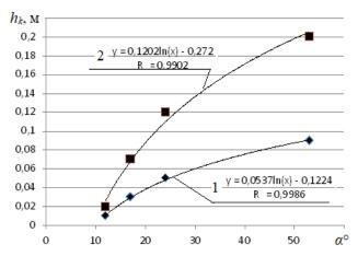
**Рис. 8.** Зависимость глубины колеи от угла наклона поверхности склона
