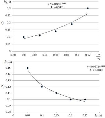
**Рис. 3.** Влияние характеристик профиля поверхности движения на глубину колеи
