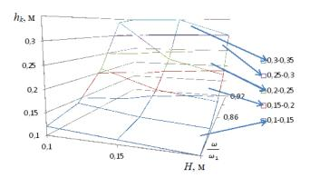
**Рис. 4.** Совместное влияние характеристик профиля поверхности движения на глубину колеи
