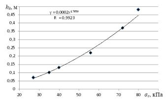
Рис. 6. Влияние давления в шинах на глубину колеи
