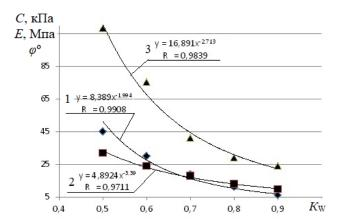
**Рис. 2.** Влияние роста влажности почвогрунта на снижение показателей его упругих и прочностных свойств: I - C,  $\kappa \Pi a$ ;  $2 - \varphi^{\rm o}$ ; 3 - E,  $M\Pi a$
