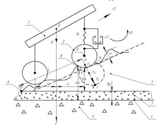
**Рис. 1.** Схема динамической двухосной колесной лесной машины (трелевочной системы) при определении глубины колеи
