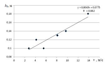
**Рис. 5.** Влияние скорости движения колесной лесной машины (трелевочной системы) на глубину колеи
