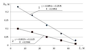
**Рис. 7.** Влияние местоположения колесной пары на глубину колеи:  $I - \sigma_c = 56$  кПа;  $2 - \sigma_c = 35$  кПа
