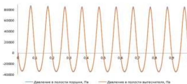
Рис. 12. Изменение давления в полостях поршня и вытеснителя
