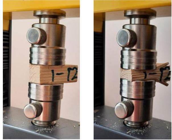
Рис. 5. Испытуемый образец до сжатия (а) и после сжатия (б)
