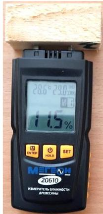
Рис. 4. Измерение влажности образцов
