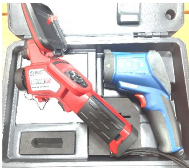
Рис. 4. Тепловизор *SDS HotFind* и ИК термометр СЕМ
