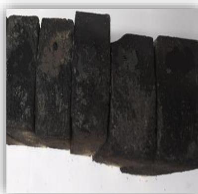
**Рис. 4.** Образцы древесины после проведения огневых испытаний: образцы с нанесением жидкого стекла с добавлением кремнеземного порошка
