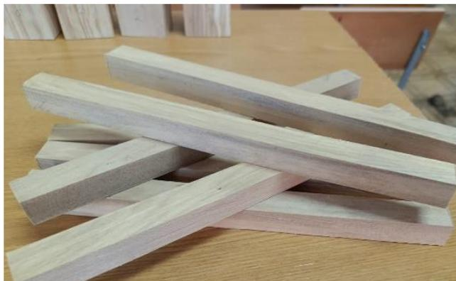
Рис. 1. Внешний вид образцов древесины затопленной березы, подготовленной для испытаний
