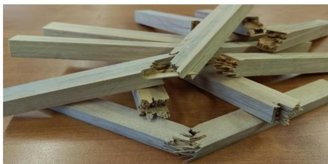
**Рис. 4.** Образцы затопленной березы после испытаний на статический изгиб
