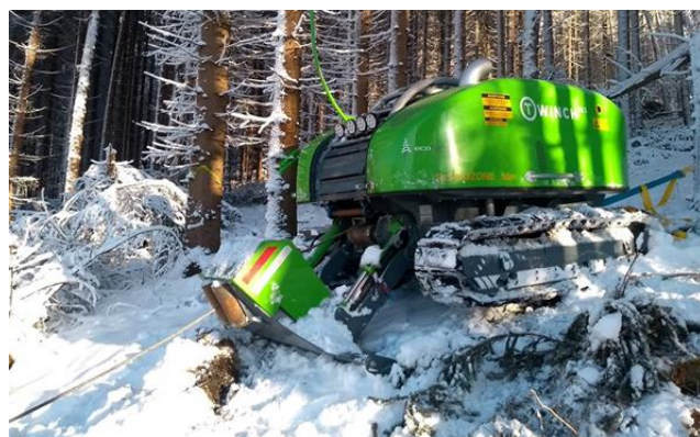
Рис. 2. Самоходная лебедка T-winch
