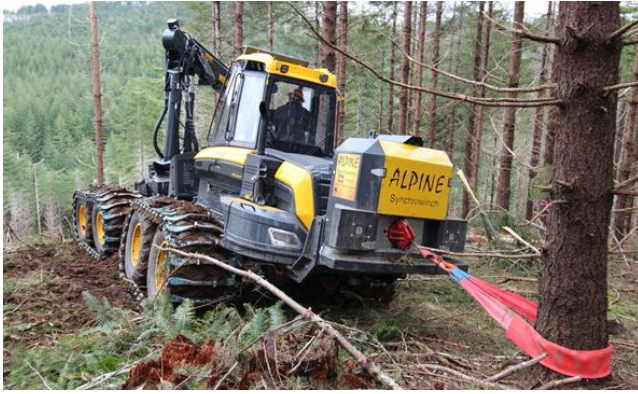
Рис. 3. Харвестер, оснащенный лебедкой Synchrowinch
