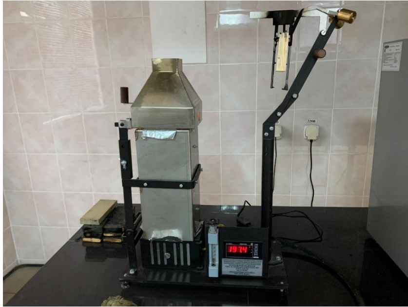
Рис. 2. Установка для определения огнестойкости образцов древесины ОТ-1
