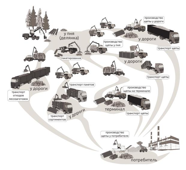
Рис. 1. Технологические цепочки получения топливной щепы при сплошнолесосечной сортиментной технологии.
