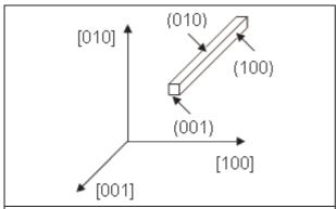
Рис. 1. Нитевидны*q* кристалл и кристаллографическая индексация граней и направлений в кристалле
