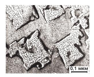
Рис. 6. Картина декорирования золотом поверхности боковой грани (100) обработанного нитевидного кристалла NaCl
