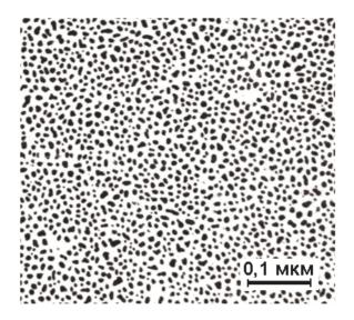
Рис. 5. Картина декорирования золотом поверхности боковой грани исходного нитевидного кристалла NaCl
