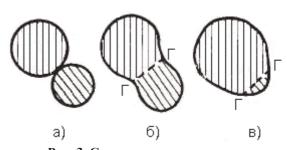
Рис. 3. Схема срастания частиц при коалесценции:
