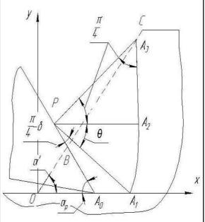
Рис. 4. Расчетная схема резания при  $\delta \ge \pi/2 - \alpha_p$ .
