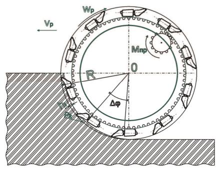
Рис. 1. Расчетная схема разработки грунта траншейным экскаватором.
