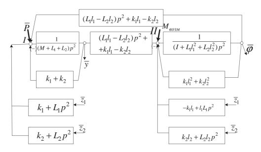
Рис. 3. Структурная схема системы в координатах  $y, \varphi$  с дополнительными связями  $L_1 p^2$  ,  $L_2 p^2$
