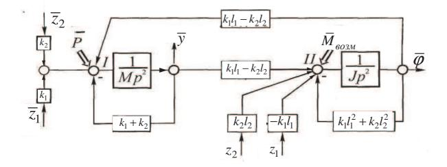
Рис. 2. Структурная схема базовой модели в системе координат у, ф
