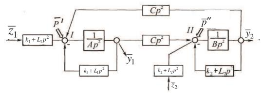
Рис. 4. Структурная схема системы с дополнительными связями.
