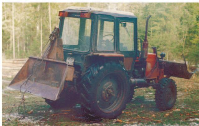
Рис. 1. Общий вид трелевочного агрегата МТЗ-82 с отвалом и лебедкой.
