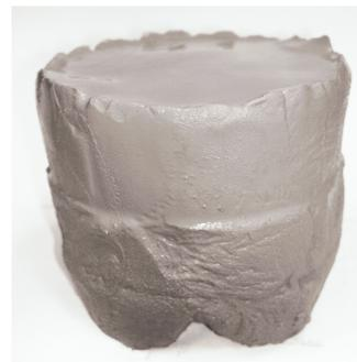
**Рис. 2.** Камневидный осадок, образовавшийся в результате седиментации суспензии биокремнезема
