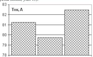
Рис. 5. Токораспределение в проводах фазы начала среднего отрезка ЛЭП ЗАС-300
