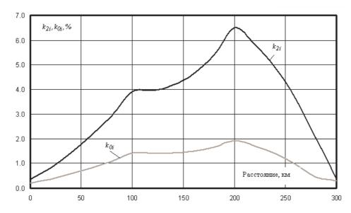
Рис. 7. Продольное распределение коэффициентов несимметрии токов
