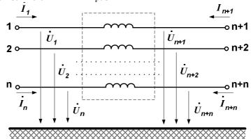
Рис. 1. Обобщенная схема многопроводного элемента электрической сети
