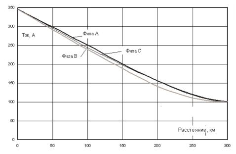
Рис. 6. Распределение фазных токов по длине ЛЭП
