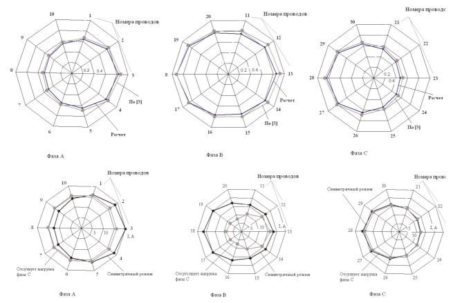
Рис. 4. Расчетные и литературные данные относительных зарядов на ЛЭП 10AC-240 и токораспределение в проводах начала среднего отрезка ЛЭП 10AC-240
