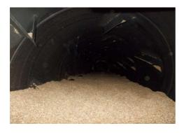
Рис. 3. Внутренняя конструкция барабана
