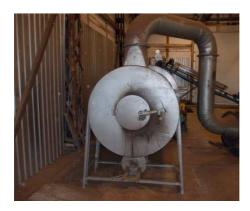
Рис. 6. Устройство выгрузки из сушильного барабана
