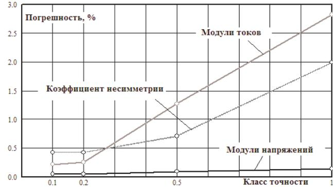
Рис. 5. Максимальные погрешности определения модулей напряжений и токов, а также коэффициента несимметрии по обратной последовательности
