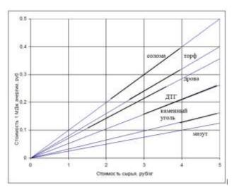
**Рис.** Зависимость стоимости 1 МДж тепла от стоимости топлива (жирными линиями обозначена наиболее вероятная цена сырья)
