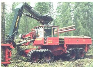
Рис. 8. Двухзахватный харвадер
