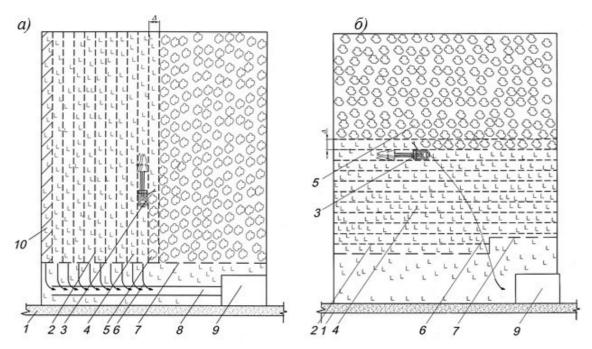
**Рис. 5.** Схемы разработки лесосек ВТПМ при сплошной рубке без сохранения подроста [19]: a — лентами, перпендикулярными к лесовозному усу;  $\delta$  — лентами, параллельными лесовозному: l — лесовозный ус; 2 — ленты; 3 — ВТПМ; 4 — пни; 5 — растущий лес;  $\delta$  — технологические ходы машины; 7 — зона безопасности; 8 — магистральный трелевочный волок; 9 — погрузочный пункт; l0 — холостой волок;  $\Delta$  — ширина разрабатываемой ленты
