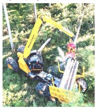
Рис. 3. Работа харвардера при раскряжевке
