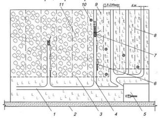
**Рис. 6.** Схема разработки лесосек ВТПМ по узкопасечной технологии с сохранением подроста [19]: I — магистральный трелевочный волок; 2 — лесовозный ус; 3 — граница зоны безопасности; 4 — пасечный трелевочный волок; 5 — верхний склад; 6 — деревья, спиленные при разрубке волока; 7 — ВТПМ; 8 — граница пасек; 9 — сохраненный подрост; 10 — семенные деревья; 11 — насаждение до рубки
