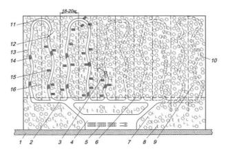
**Рис.** 7. Схема разработки лесосеки при выборочной рубке по скандинавской технологии [19]: I — лесовозный ус; 2 — магистральный трелевочный волок; 3 — производство сортиментов; 4 — погрузочный пункт; 5 — штабель сортиментов; 6 — граница зоны безопасности; 7 — пни; 8 — сохраненный подрост; 9 — насаждения до рубки; 10 — трасса пасечного волока; 11 — разворотное кольцо; 12 — сбор сортиментов; 13 — пасечный трелевочный волок; 14 — порубочные остатки; 15 — пачки сортиментов; 16 — граница пасек
