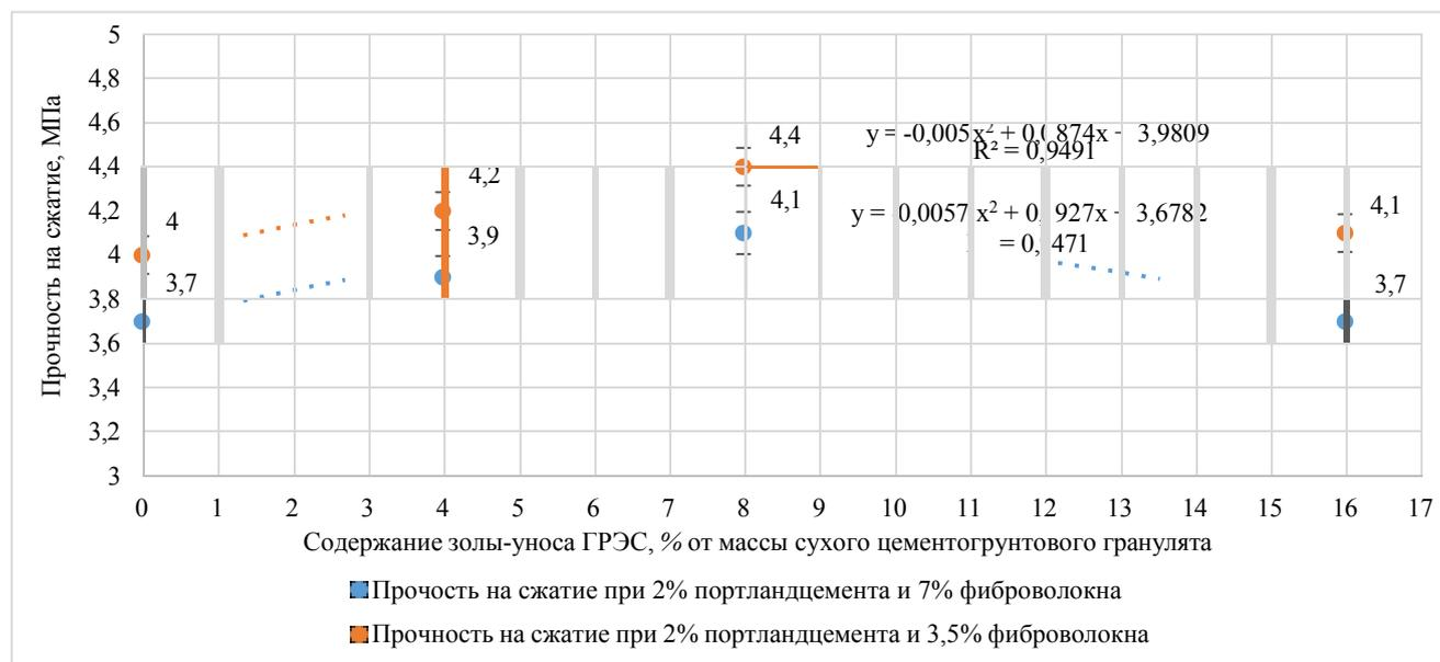
**Рис. 1.** Зависимость прочности на сжатие регенерированной цементогрунтовой смеси от содержания золы-уноса ГРЭС
