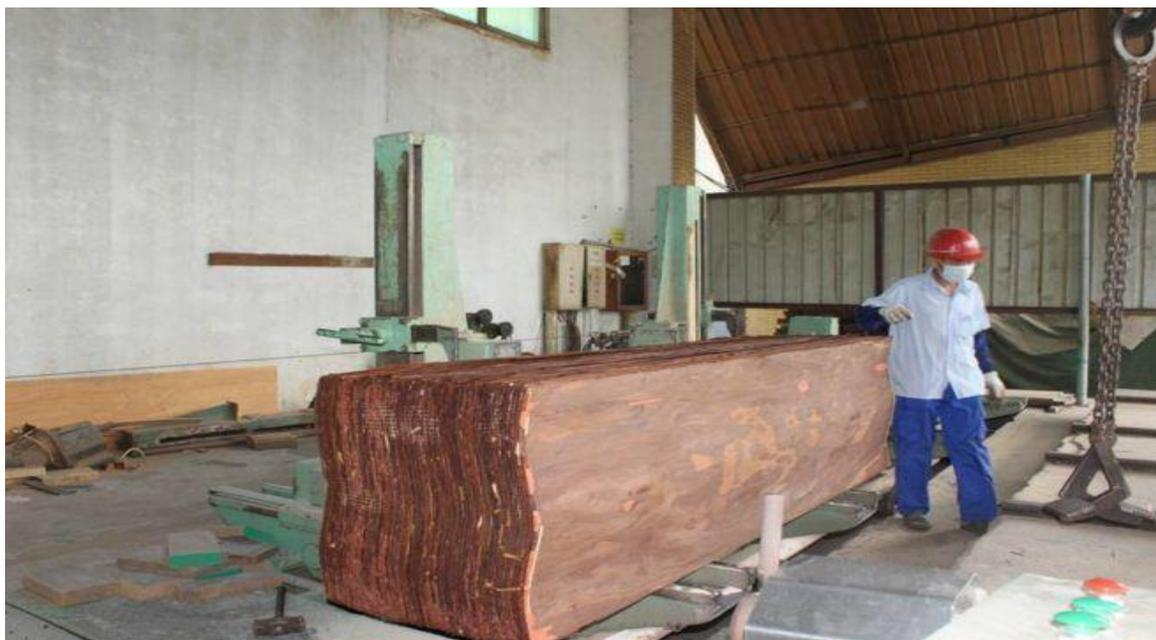
**Рис. 1.** Спрессованный блок шпона перед строганием
