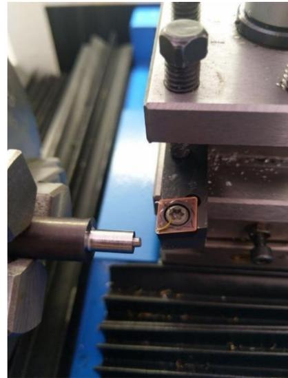
Рис. 2. Внешний вид заготовки и резца при испытаниях
