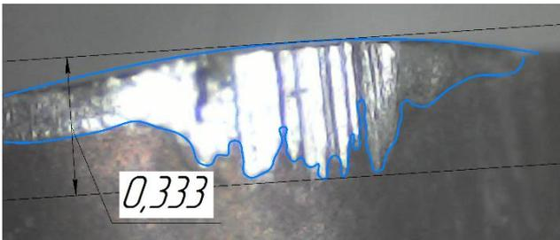
Рис. 5. Измерение износа режущей пластины
